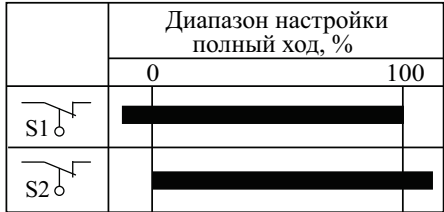
Диаграмма работы микровыключателей блока сигнализации ИМ Z1 ... Z3 ■ -- Контакт замкнут
